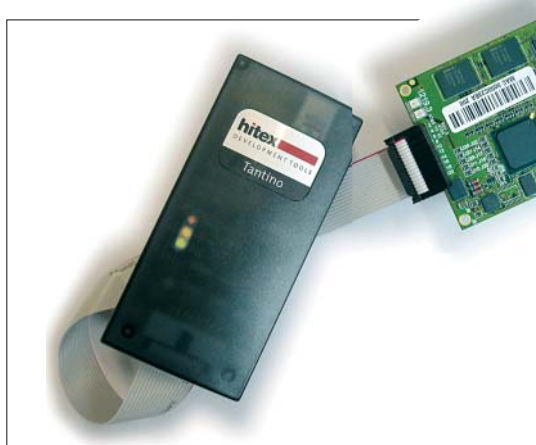
Bild 3: Neben den internen Flashes von ARM7- und ARM9-basierenden General-Purpose-Controllern sowie XScale können auch alle gängigen externen Flash-Bausteine programmiert werden mit dem TantinoFLASH von Hitex programmiert werden.
