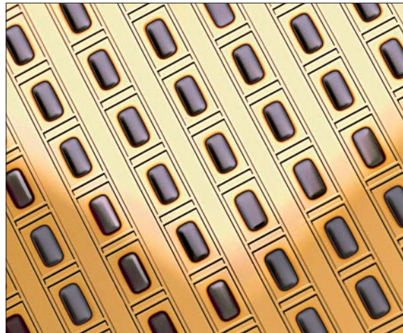
Bild 3: Der Kapfen-Wafer weist eine matrixförmige Anordnung von Kavitäten auf.
