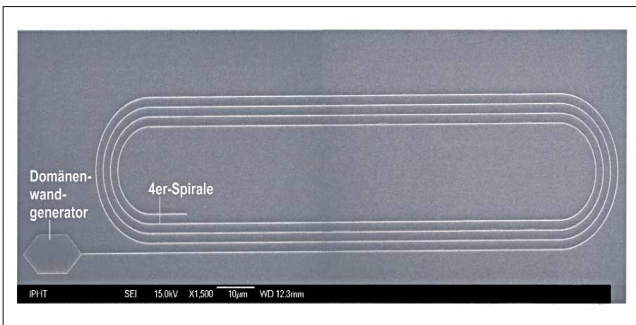
Bild 4: Der GMR-Sensor besteht aus einem so genannten Domänenwandgenerator und einer bestimmten Anzahl von Spiralarmen. Die Anzahl der Spiralarme entscheidet darüber, wie viele Umdrehungen gezählt werden können.
