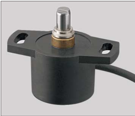
Bild 3: Der auf dem GMR-Effekt basierende Multiturn-Sensor kann zusätzlich zum Drehwinkelsignal im stromlosen Zustand ohne Pufferbatterie und ohne Getriebe derzeit bis zu zwölf Umdrehungen zählen und dauerhaft speichern.
