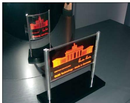
Bild 3: Dieses symbolträchtige OLED aufgebaut mit Material von Novaled demonstriert den transparenten Aufbau.
