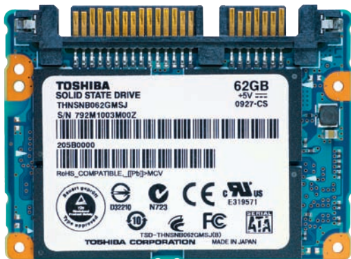
Bild 2: SSDs enthalten eine große Anzahl nicht flüchtiger Speicherbausteine und zusätzlich einen 32-Bit-Embedded-Prozessor sowie Firmware.
