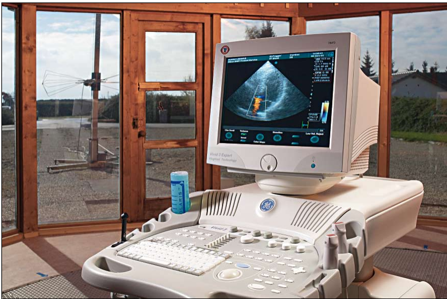
Bild 2: Freifeldmessung an einem Ultraschalluntersuchungsgerät
