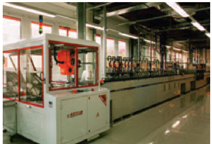
Bild 2: Mit ihrer modernen Ätzlinie für Innenlagen der Gebr. Schmid GmbH & Co. setzt die Vogt Electronic Fuba GmbH die Tradition der in Gittelde eingeführten High-Tech-Ausrüstung auch im Werk Dresden fort. Ergänzt wird die Anlage mit KSL Aufstaplern der Kuttler Automation Systems GmbH
