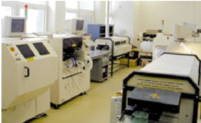
Bild 4: Zwei weitere SMT-Linien für Klein- und Mittelserien
