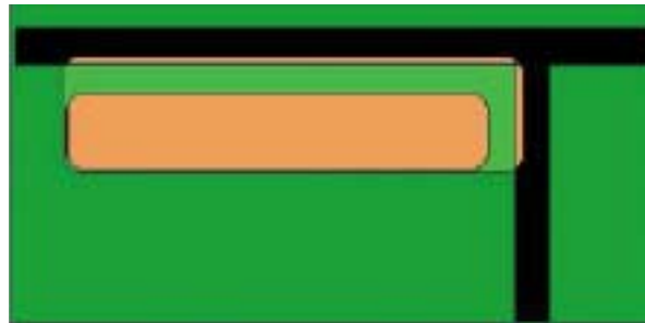
Bild 1: Ist die Lötstopmaske nicht zentrisch um die Anschlussfläche aufgebracht, besteht die Gefahr von Lötbrückenbildung zwischen Anschlusspad und benachbarter Leiterbahn, da der minimale elektrische Abstand zwischen Pad und Leiterbahn nicht eingehalten wird
