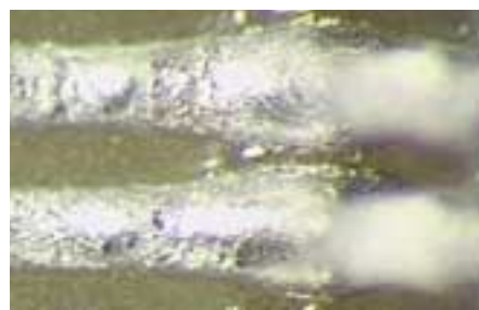
Bild 3: Das Lotpastenpad wurde zu groß gewählt bzw. die Schablonenstärke zu dick. Während des Reflowlötens bilden sich Lotballen an den Bauteilanschlüssen. Diese reduzieren den Isolationsabstand zwischen den Bauteilanschlüssen und können ein erhöhtes Kurzschlussrisiko bedeuten, z.B. durch Lotkugeln. Mögliche Lösung: Reduzierung der Lotpastenpadlänge
