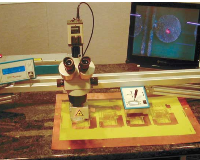
Bild 1: Laserbasierte Reparaturstation LaserScalpel von LPKF
