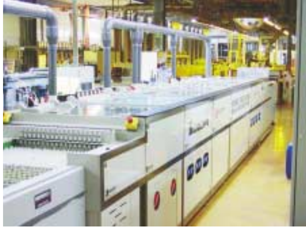
Bild 4: Schwarzoxid-Ersatz in der Multilayerfertigung: Occleppo-Linie bei Straschu
