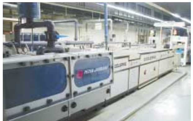
Bild 3: Occleppo-Linie für Saures Ätzen und Alkalisches Strippen bei der SKM Electronic GmbH
