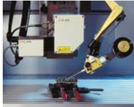
Bild 2: Diodenlaser DLx12 mit interner CCD-Kamera, Pyrometer und Lotdrahtvorschubeinheit
