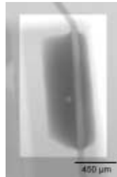
Bild 5: Röntgenaufnahme eines mit Lotdraht gelöteten Sensors (Ausschnitt). Es sind fast keine Poren zu erkennen. Das Anschlusspad ist mit einem Kupferdraht mit 75 µm Durchmesser kontaktiert
