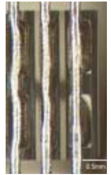
Bild 3: Sensor mit Laser im Reflow-Verfahren kontaktiert
