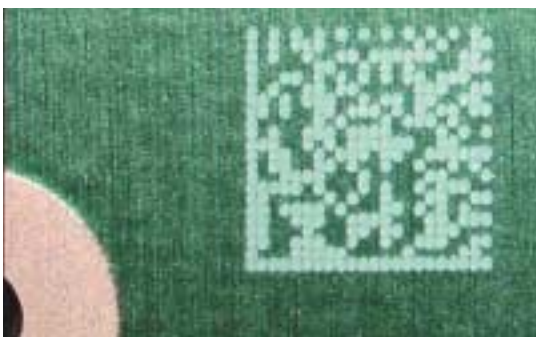
Bild 1. Data Matrix Code (DMC) in Lötstopplack eingelasert
