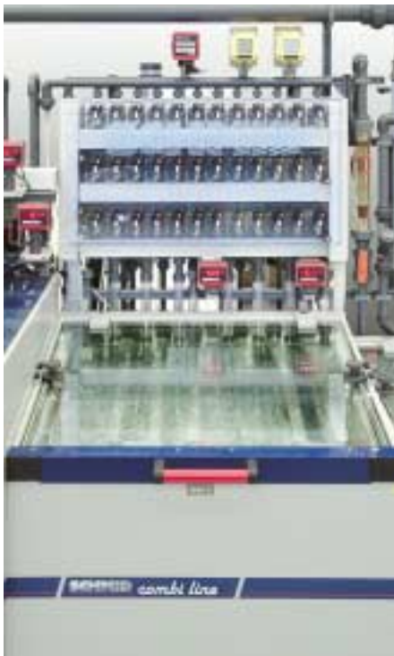
Bild 1: Das intermittierende Ätzmodul mit Einzeldüsenansteuerung sorgt für eine größere Flexibilität, da alle Plattenformate gefahren werden können und auch eine zweibahnige Produktion möglich ist
