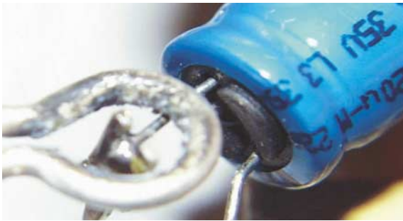
Bild 3: Induktionslötschleife zum Anlöten eines Bauelements
