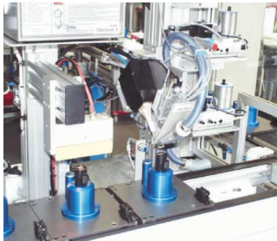
Bild 6: Induktionslötsystem mit Vorwärmstation
