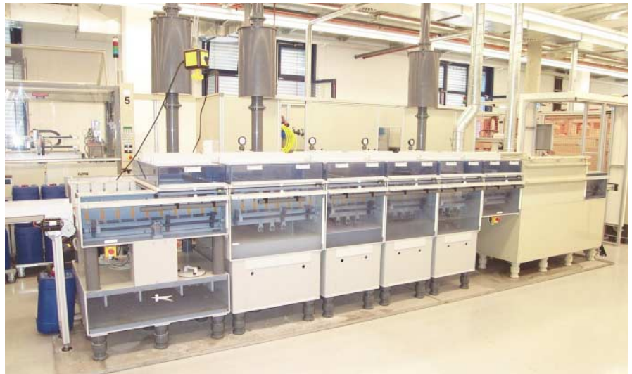
Bild 2: Inline-Anlage von Pill für den Vigon A 200-Prozess von Zestron bei Beru in Bretten
