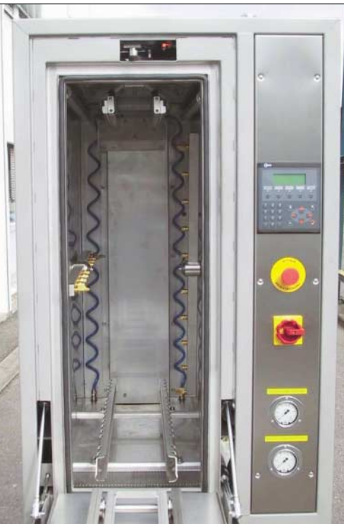
Bild 1: Die Multifunktionsanlage von Systronic ermöglicht durch unterschiedliche Aufnahmesysteme die Reinigung von Schablonen, Sieben, Lötrahmen, Kondensatfallen und Baugruppen beziehungsweise Misprints in einem Vier-Phasen-Prozess: Waschen, Abtropfen, Spülen, Trocknen
