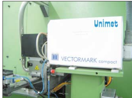
Bild 3: Der Unimet-Laser sorgt für exzellente Lesbarkeit der vorgegebenen Buchstaben bzw. Zahlencodes
