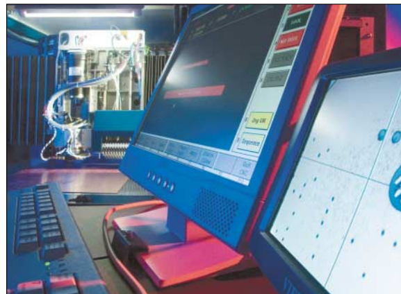
Bild 3: Mehr Flexibilität mit der Einspindler-Bohrmaschine Micronic 81 durch doppelseitige Magazine, bedienbar über Touchscreen und separates Sichtfenster des aktuellen Arbeitsausschnittes
