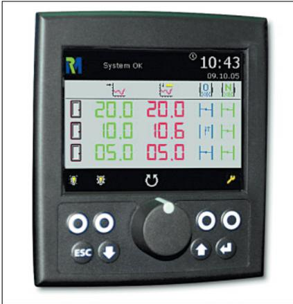
Bild 3: Farbgrafikdisplay zur Anzeige von Daten und Alarmmeldungen
