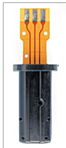
Bild 3: Erstes Umspritzen der Flexschaltung
