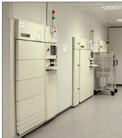
Bild 5: Burn-in erhöht die Qualität der ausgelieferten Speichermodule
