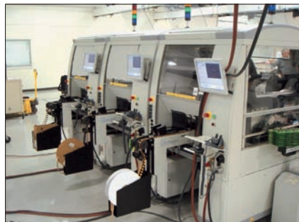
Bild 3: Rückansicht der drei Unovis-Polaris-Assembly-Zellen, die für die Odd-form-Platzierung zuständig sind (Foto: Grundfos)
