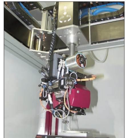
Bild 4: Das Laserlötwerkzeug wird durch ein vierachsiges NC-Handhabungsgerät mit Servoantrieb an beliebigen Lötstellen positioniert
