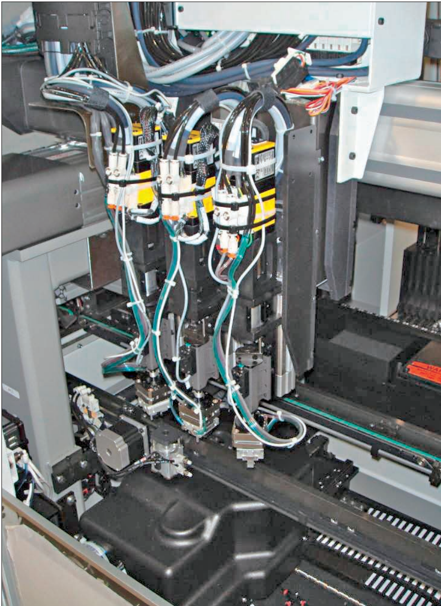
Bild 5: Kundenspezifische Tools zur Oddform-Assemblierung der Alpha2 mit Gang-Pick- und Floating-Head (Foto: Grundfos)
