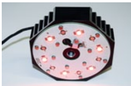
Gezielte Wärmeableitung von Hot-Spots
