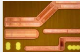
Profile verschiedener Breite (2, 4, 8, 12 mm x 0,5 mm)
