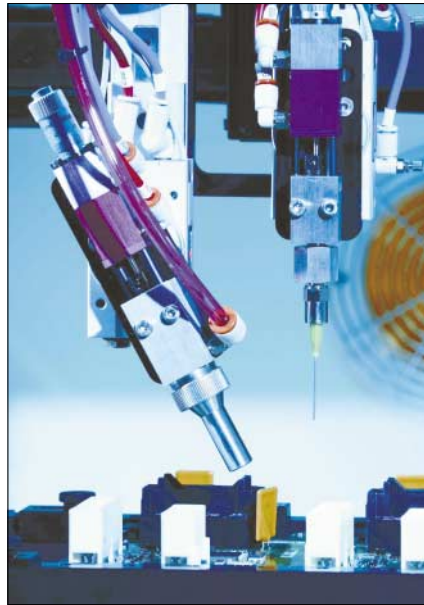
Bild 3: Vollständige Beschichtung auf der Oberseite der Bauteile und Dispensen in einem bestimmten Winkel nur von der Seite
