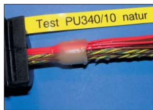
Bild 4: Längswasser-Abdichtung mit dem Verfahren von ECM-Stuis
