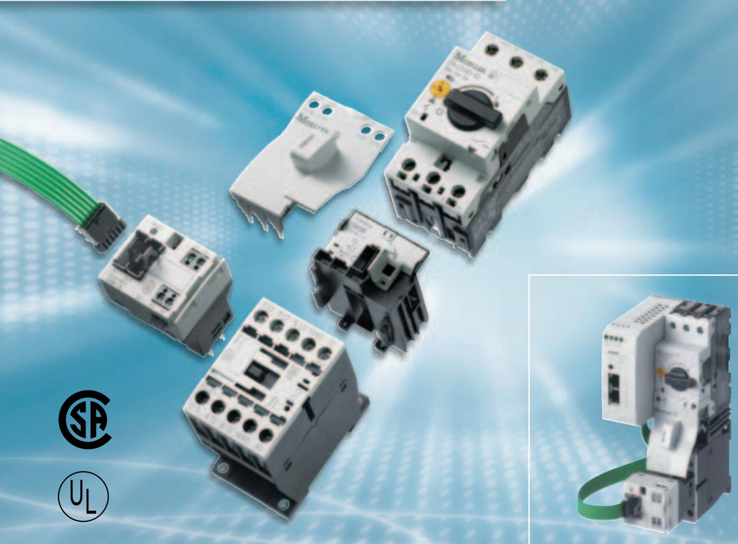
SmartWire erlaubt den Anschluss von Schaltgeräten an eine SPS ohne aufwändige Steuerstromverdrahtung. Die Steuerstromverdrahtung zwischen der Steuerung und den Schaltgeräten wird ersetzt durch steckbare, vorkonfektionierte Verbindungsleitungskabel. Der Verdrahtungsaufwand wird drastisch reduziert und Verdrahtungsfehler gehören damit der Vergangenheit an. Das bringt Einsparungen bei der Montage, Inbetriebnahme und der Fehlersuche im Betrieb.
